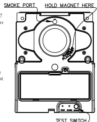
FIGURE 8. DH-100-P TEST LOCATIONS
